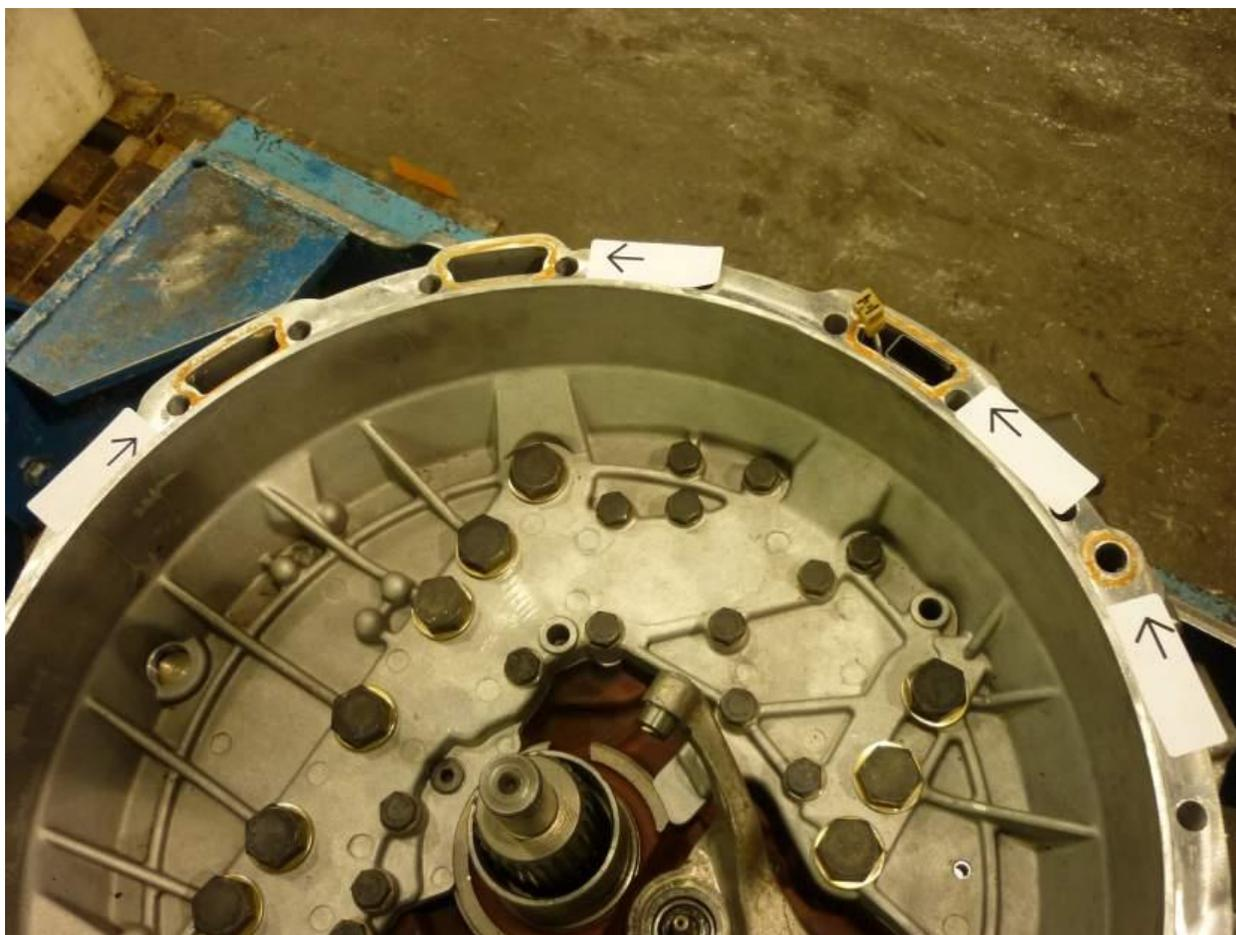
Figure 1 : Carter d'embrayage et carter en contact (non illustré) – Application du produit d'étanchéité Loctite 574
