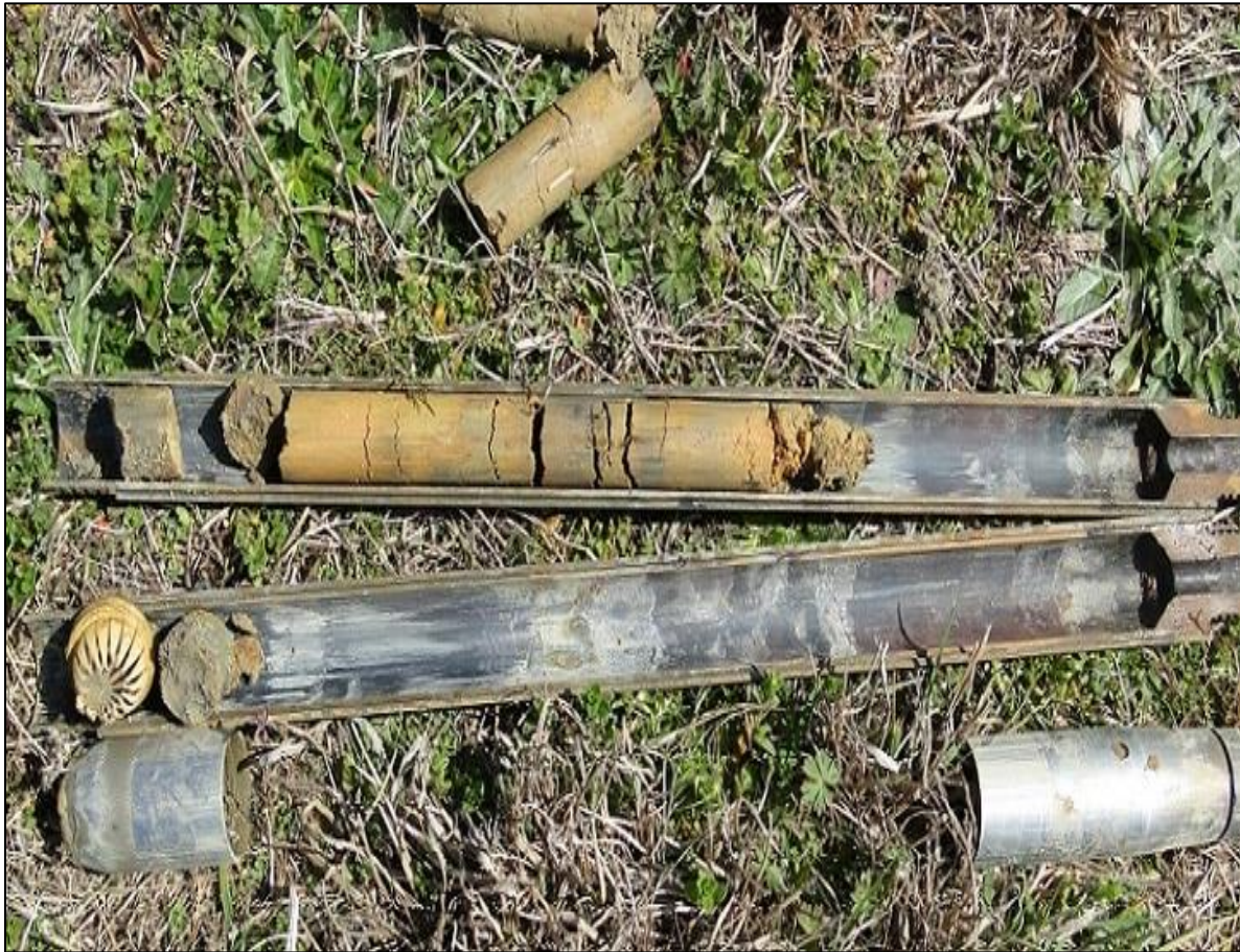
Photo 3. Échantillonneur à cuillère fendue monté sur un appareil de forage.
