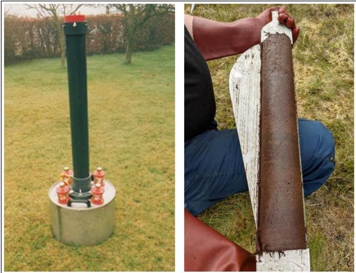
Photo 2. À gauche : carottier Mackereth submersible. À droite : carottier russe sumersible.
