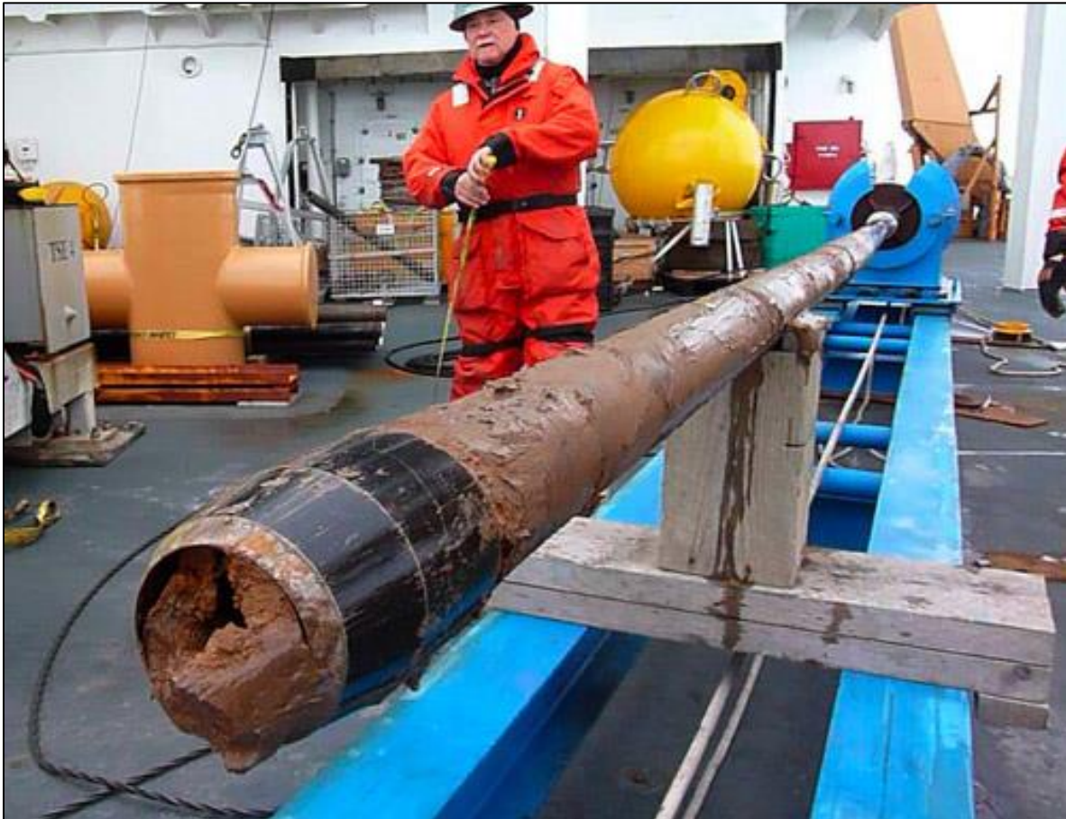
Photo 5. Échantillon prélevé avec un échantillonneur à piston.
