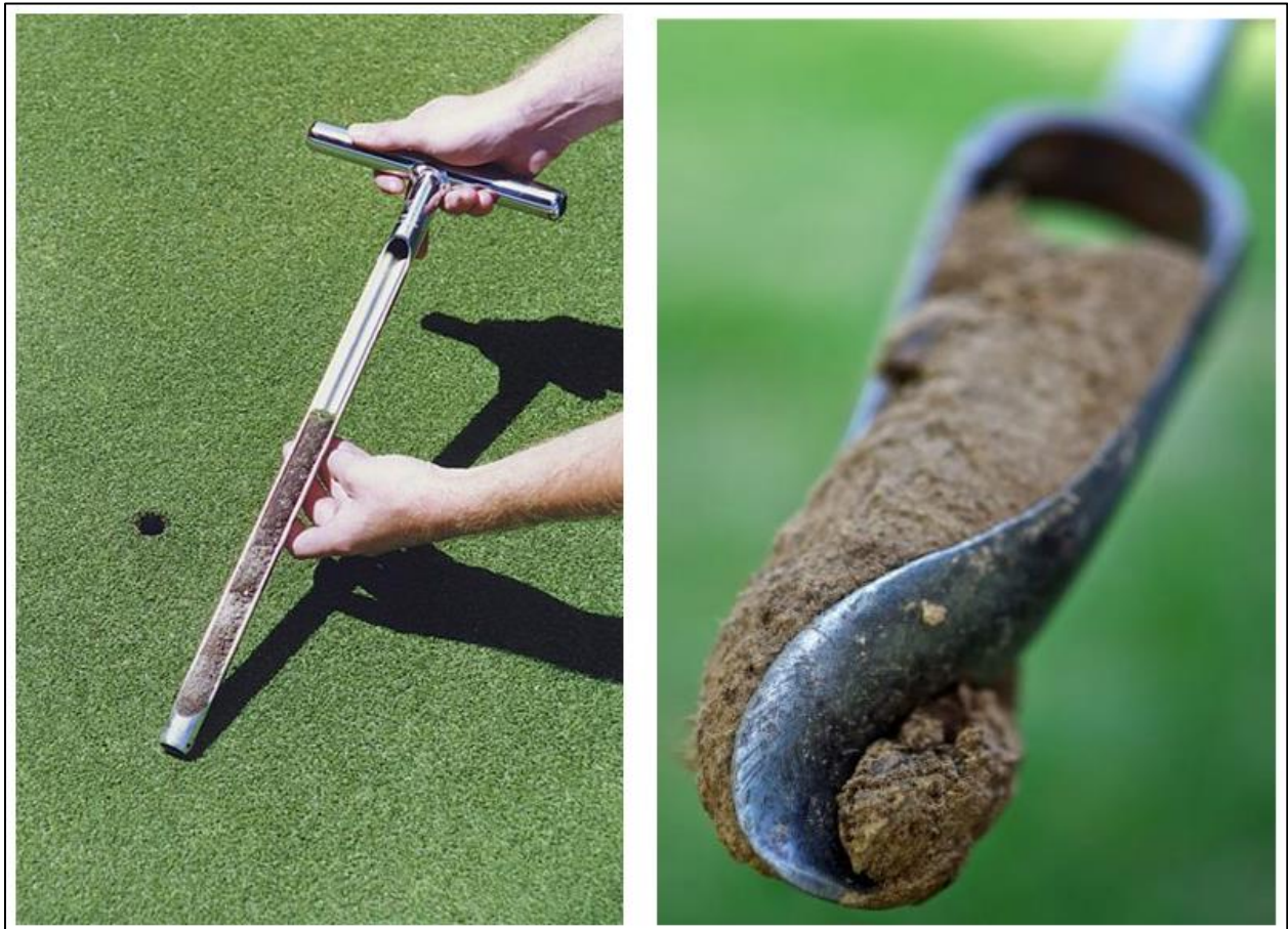
Photo 1. À gauche : échantillonneur manuel à piston. À droite : échantillonneur manuel à tarière.
